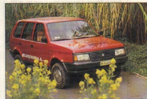
Santa Margherita Ligure (Genova). Il "Magnum 4x4" Rayton Fissore, nella versione "Turbodiesel Intercooler", presenta una linea sostanzialmente immutata. Nuovo invece il motore, l'ormai famoso quattro cilindri di 2400 centimetri cubi prodotto dalla VM di Cento.
