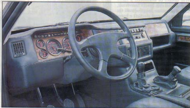
La plancia ha uno stile molto personale, con la parte centrale sporgente verso l'abitacolo. La strumentazione è davvero completa, nutrita anche la dotazione di spie. Il volante, i pomelli del cambio e del riduttore sono rivestiti in pelle.
